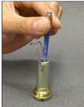
新しいヒューズを差し込む
